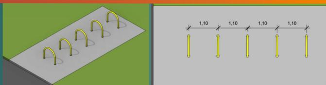
PARACICLO ISOMÉTRICA - SEM ESCALA
